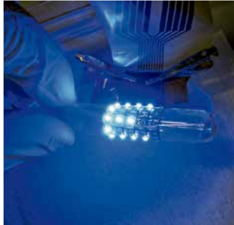
Der flexible Schaltkreis funktioniert selbst dann, wenn er gedehnt oder verbogen wird. ETH ZÜRICH
